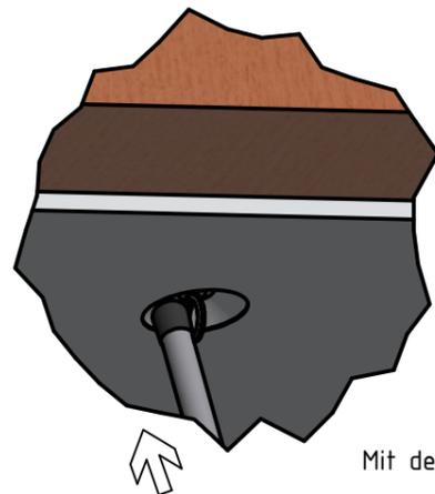
Mit dem Zugstock wie im Bild beschrieben andrücken, um Dellen im Deckel zu vermeiden.
